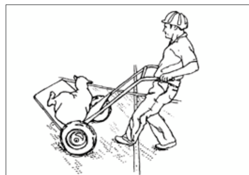
Um carrinho bem projetado para transportar animais incapacitados.
